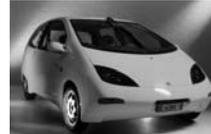
$$\left\{ \begin{array}{l} A_f \cdot c_w = 0.7 \text{ m}^2, \quad c_r = 0.012, \quad m = 1'500 \text{ kg} \\ 45 \text{ MJ}/100\text{km im EU Zyklus (17 Tafeln Schoggi ...)} \end{array} \right.$$
